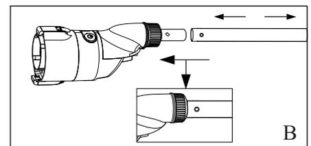
Vous pouvez remplacer la poignée par un manche télescopique (non fourni) pour le nettoyage du fond de la piscine par exemple.
