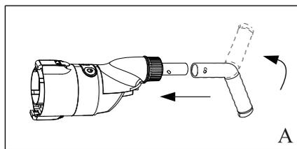
Selon le besoin, la poignée peut être fixée dans les deux sens. L'option retenue permettra de faciliter l'utilisation de l'aspirateur en fonction de la tâche (nettoyage des murs, du fond, des marches ou du spa).
